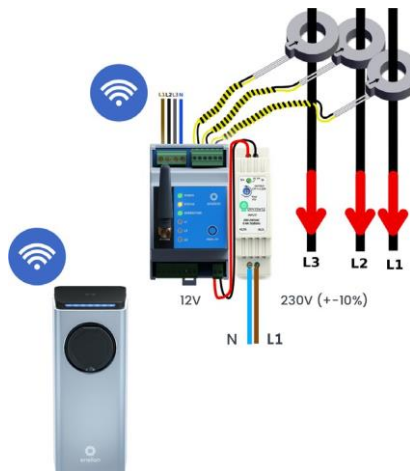
Abb. 5: Anschlussplan für die 3-Phasen-Variante von ENELION ENERGY GUARD
